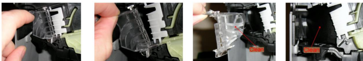
Obrázek 37: Čištění vodičů drah
