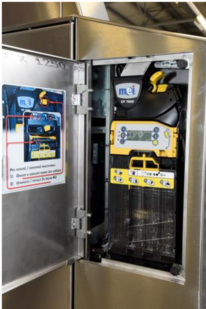
Obrázek 14: Nainstalovaný mincovník
