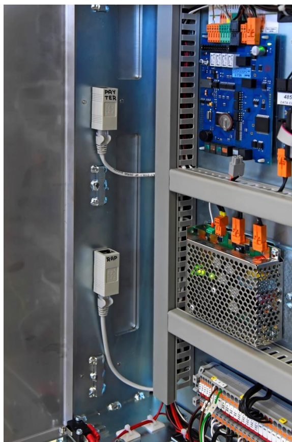
Obrázek 21: Konektor LAN pro připojení bezkontaktní platební čtečky
