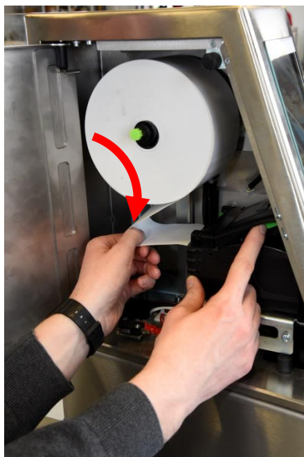
Obrázek 12: Odjištění horního krytu tiskárny a vysunutí papíru
