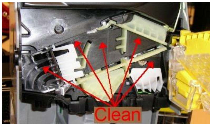
Obrázek 36: Čištění vstupních otvorů
